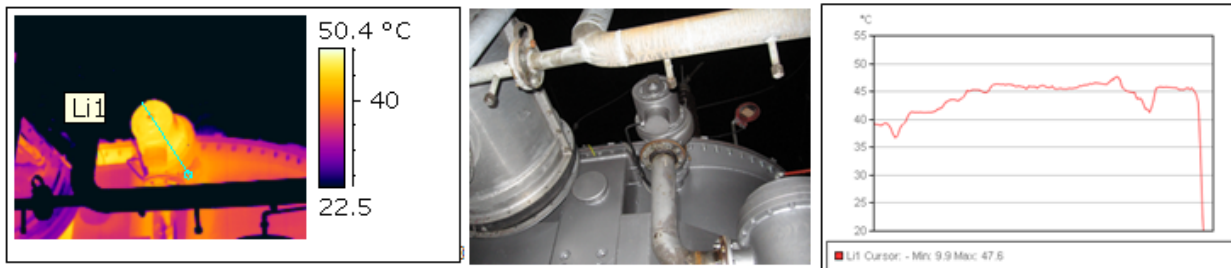
Slika broj 4 Termo- i foto slika i temperaturni profil uljne pumpe
